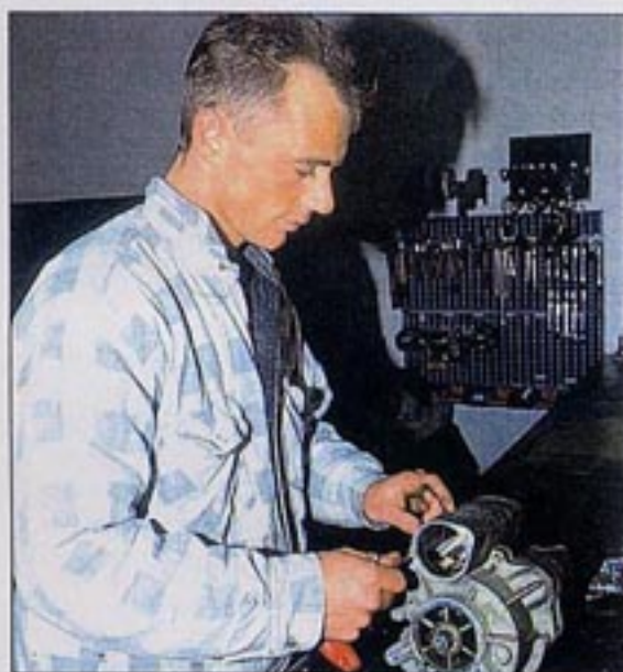
Vorbeugen ist besser als Draufzahlen - alle 50.000 km sollte der Lader gewartet werden
