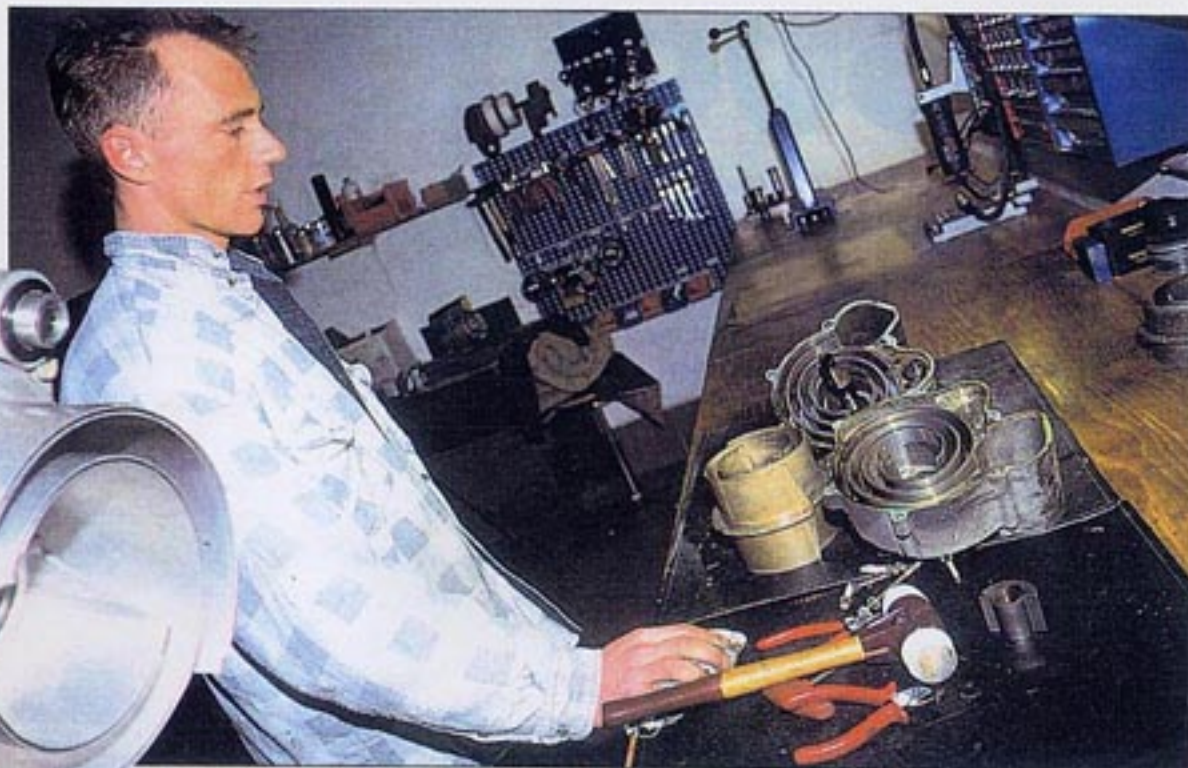
Sichtkontrolle - die Einzelteile werden auf Verschleißspuren überprüft
