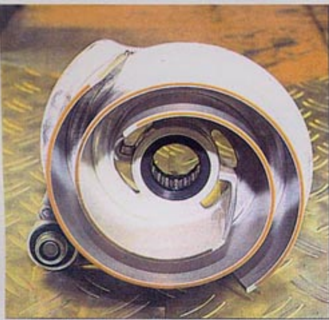
Wirbelwind - der Verdränger drückt die Luft nach innen
