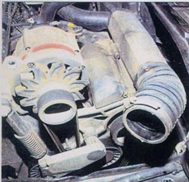
Dickes Ding - das große Gehäuse (unter dem Generator) gehört zu den Nachteilen des G-Laders
